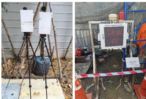
จุดที่ 1 บริเวณพื้นที่โครงการ และตรวจวัดด้วยเครื่องตรวจวัดแบบอ่านค่าทันที (Real time monitoring device)
