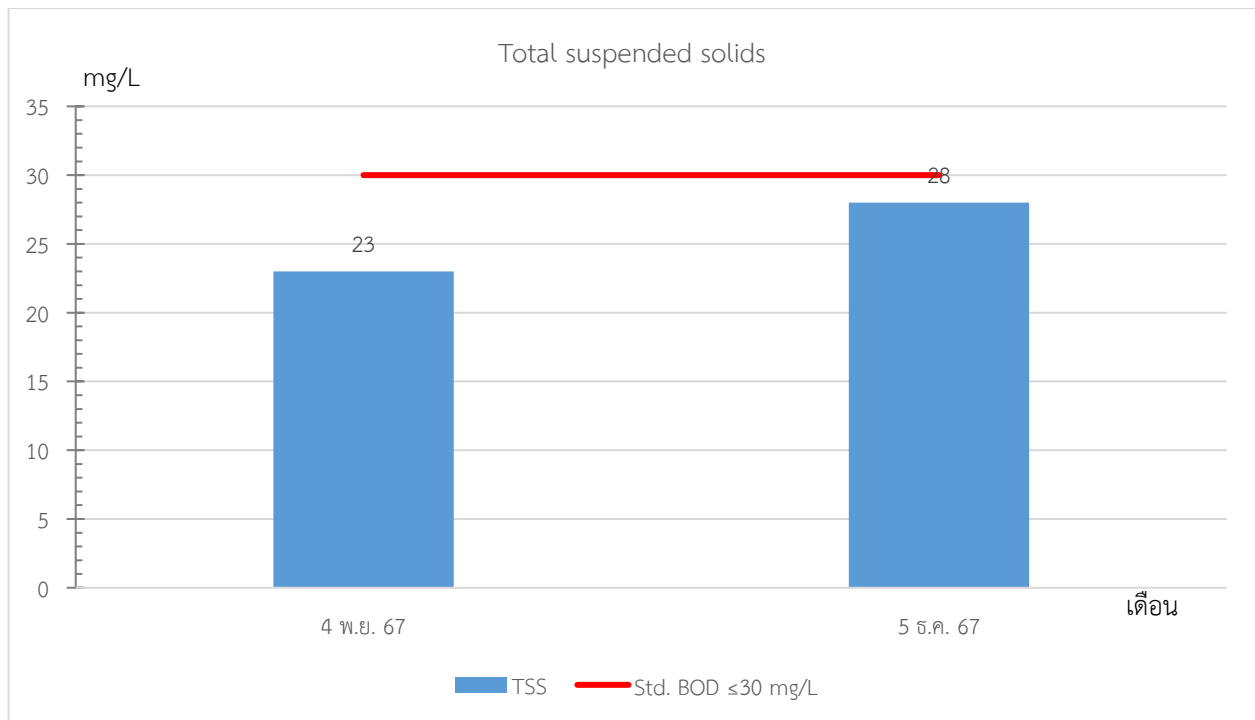
รูปที่ 3.42 กราฟแสดงผลการตรวจวิเคราะห์ TSS จุดที่ 1 คุณภาพน้ำทิ้งจากถังบำบัดน้ำเสียสำเร็จรูป บริเวณในพื้นที่ก่อสร้างโครงการ
