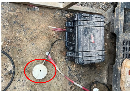
จุดที่ 1 บริเวณพื้นที่โครงการ รูปที่ 3.27 การตรวจวัดความสั่นสะเทือน
